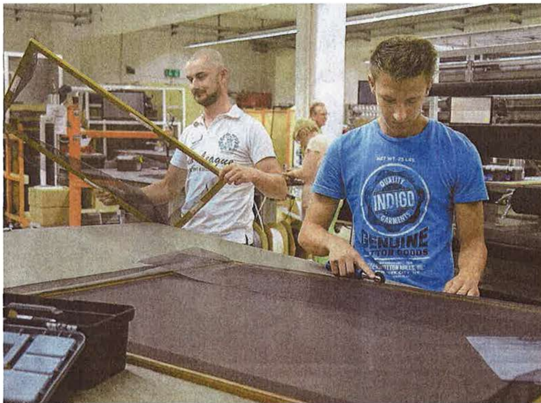
Insektenschutzgitter werden bei der Firma Erfal in Falkenstein hergestellt. Ronny Schön (rechts) zieht das Gewebe in den Rahmen ein, Teamleiter Peter Stark kontrolliert das fertige Produkt.
